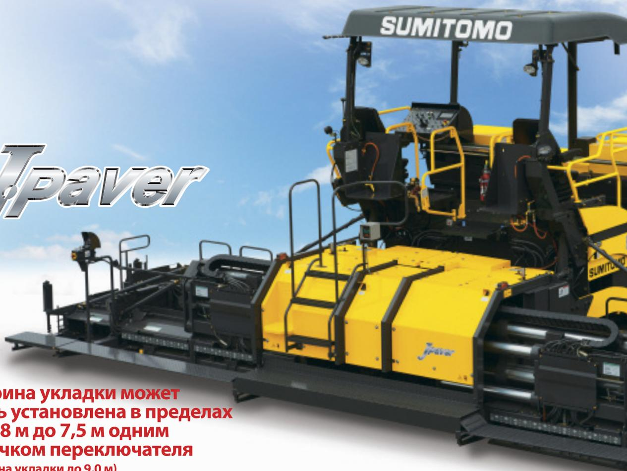
**Ширина укладки может быть установлена в пределах от 2,8 м до 7,5 м одним щелчком переключателя (ширина укладки до 9,0 м)**
