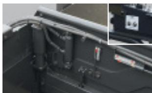
Раздвижной отвал с гидроприводом (задвинут и выдвинут)
