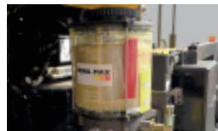
Система автоматической смазки
