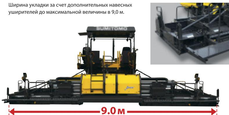
Фото укладки шириной 9,0 м (максимальная ширина укладки)
